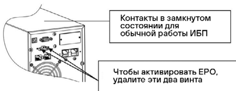
Рисунок 3. Разъем аварийного отключения EPO
